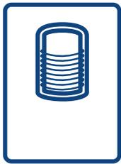
Lo scambiatore avvolto a contatto con l'esterno del serbatoio impedisce che si formi calcare, prolungando la vita del boiler.
